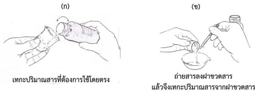
รูปที่ 1.9 การเทสารเคมีที่เป็นของแข็ง
