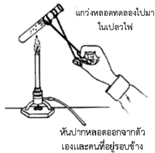
รูปที่ 1.8 การดึงสารเคมีในหลอดทดลอง
